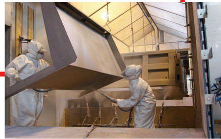
Zinc primer application
